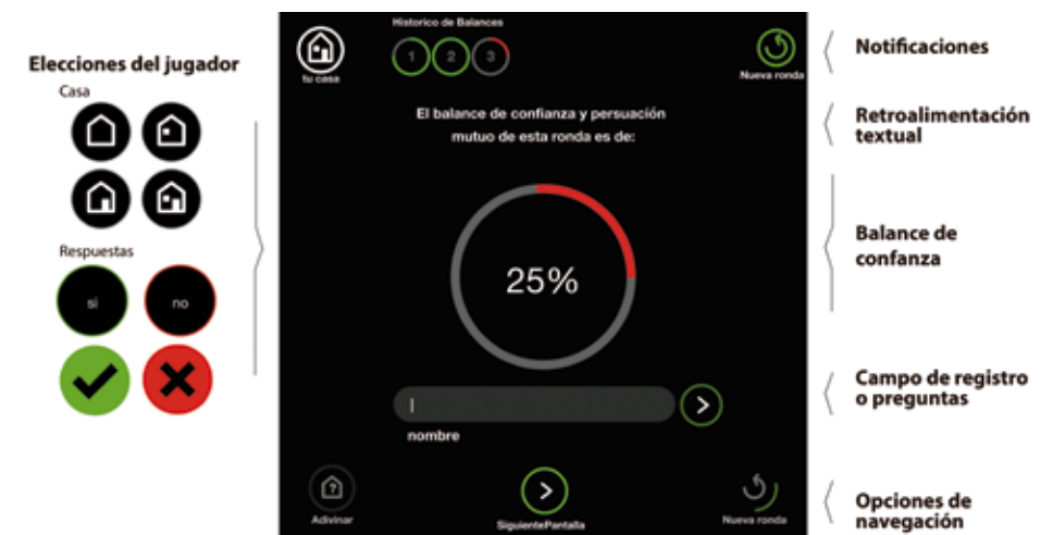
Figura 2. Descripción de los elementos de las pantallas de la interfaz gráfica de la aplicación cliente/servidor. Autores: Alejandro Sanclemente y Andrés Bonilla.
